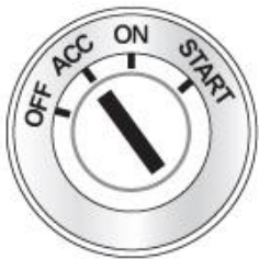
② ACC 상시전원 상태 차량 내 전원이 ON되는 상태
