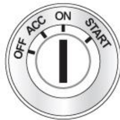
③ ON 상태 엔진 등 주요 시스템 체크 및 작동 가능상태
