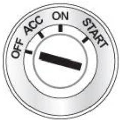
① Key-off 상태 차량 내 전원 차단 및 슬립모드 상태가 됨
